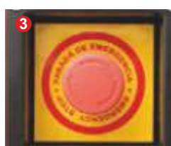
3 Кнопка аварийной остановки
